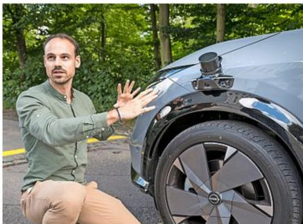
Andreas Jossen erklärt den über dem Radkasten montierten Lidar-Sensor, der den toten Winkel des Fahrzeugs überwacht.
